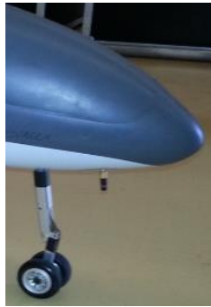
Figura 2.1 - Monopolo \frac{1}{4} \lambda implementado no UAV
