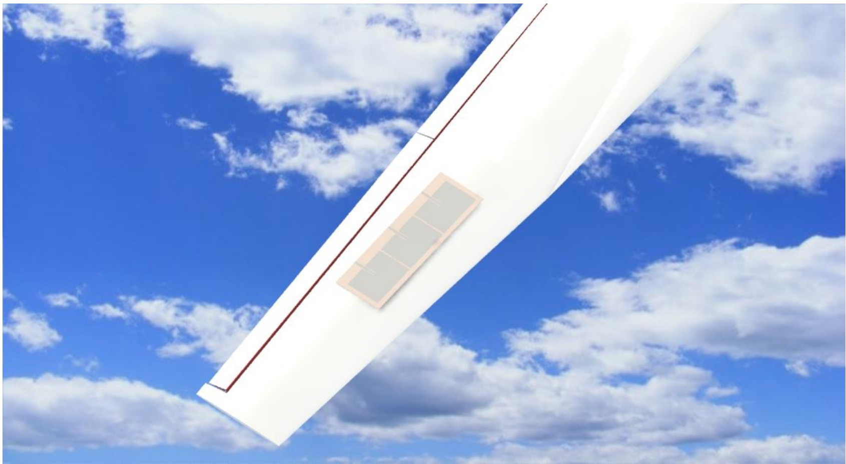
Figura 6.4 – Fotografia realizada pelo programa Solidworks numa escala real representando a asa do UAV com a antena P-ESPAR colocada.
